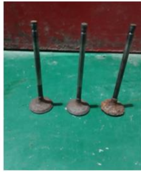
Gambar 3.11 Valve intake bekas.
