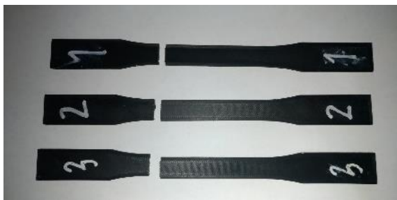
Gambar 7 Pola Patahan Pada Sesimen ABS
