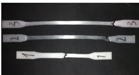
Gambar 8 Pola Patahan Pada Sesimen nilon
