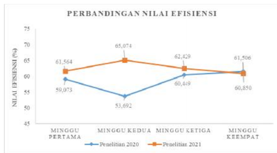
Gambar 4. 1 Grafik hubungan interval waktu dengan Perbandingan Efisiensi Steam Turbine Generator 1 Pasca Overhaul dan setelah 1 tahun beroperasi.
