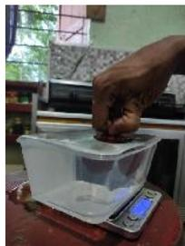
Gambar 4.3 Proses Pencelupan Balon Berisi Gas Hidrogen
